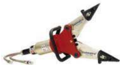
Rozpieracz SP 3260+ - produkowany przez holmatro, ma maksymalną moc rozpierania 20 ton, a przy ramionach zamkniętych (25mm od końcówek) 6 ton. Siła ciągnięcia wynosi 11 ton.
