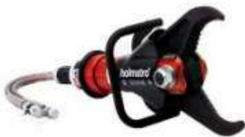
Nożyce CU 3040 GP - są to najsilniejsze nożyce hydrauliczne produkowane przez firmę Holmatro, siła cięcia tych nożyc wynosi 48 ton, pracując na ciśnieniu roboczym 720 bar.
